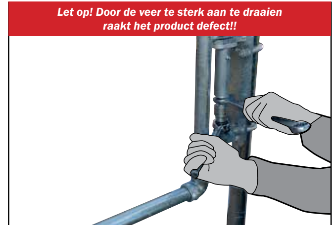
N. Zodra de poort geheel gesloten is, de moer vastdraaien zodat de spanning in stand wordt gehouden. Let op: Blijf de ratel stevig vasthouden en laat deze pas los als de borgmoer is vastgedraaid. Verwijder de dopsleutel en ringsleutel nu van het scharnier. Herhaal de procedure zo nodig totdat de poort goed sluit zodra deze is geopend en wordt losgelaten.
